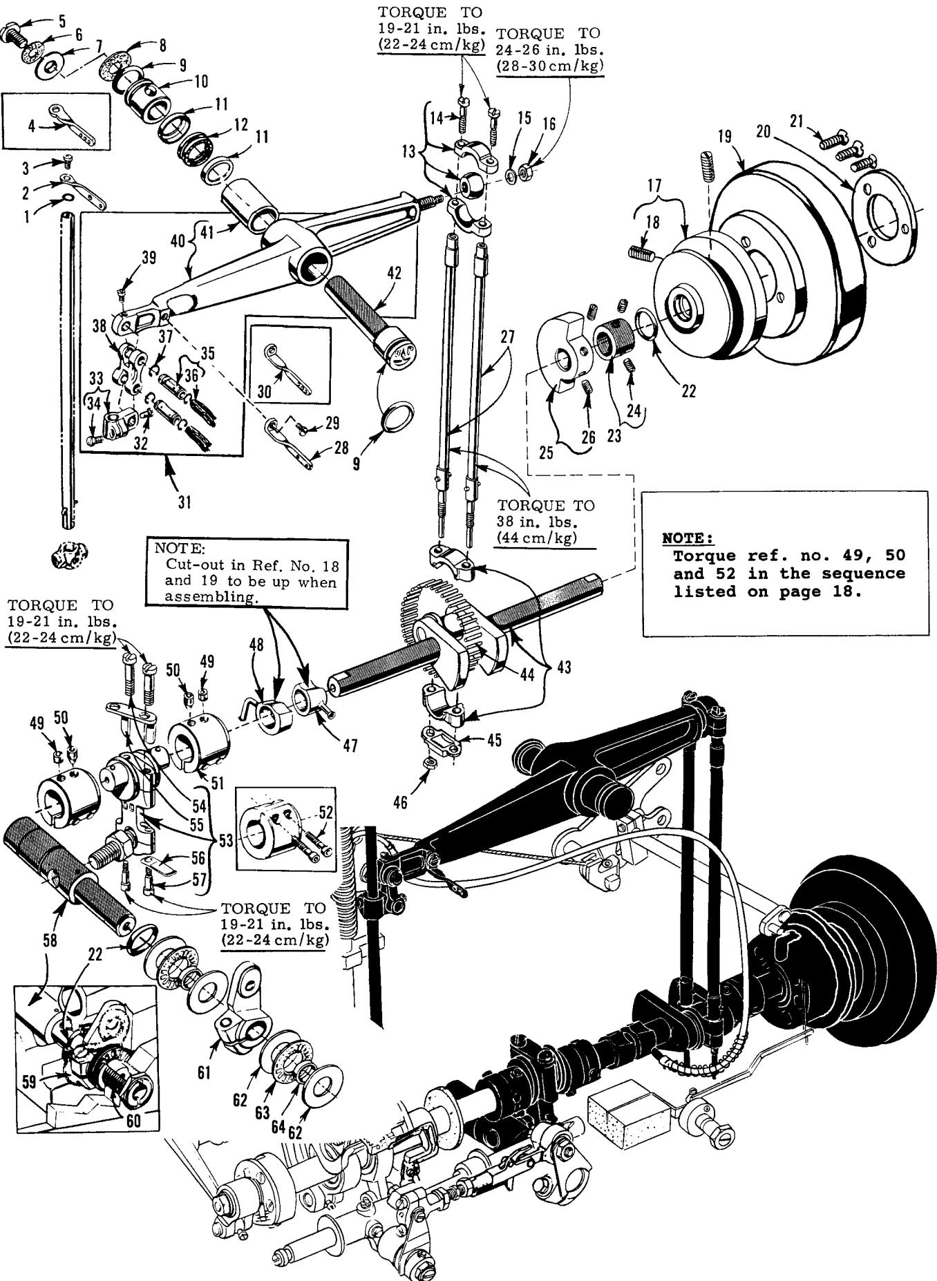
**CRANKSHAFT, NEEDLE LEVER & LOOPER DRIVING PARTS CONT.**
