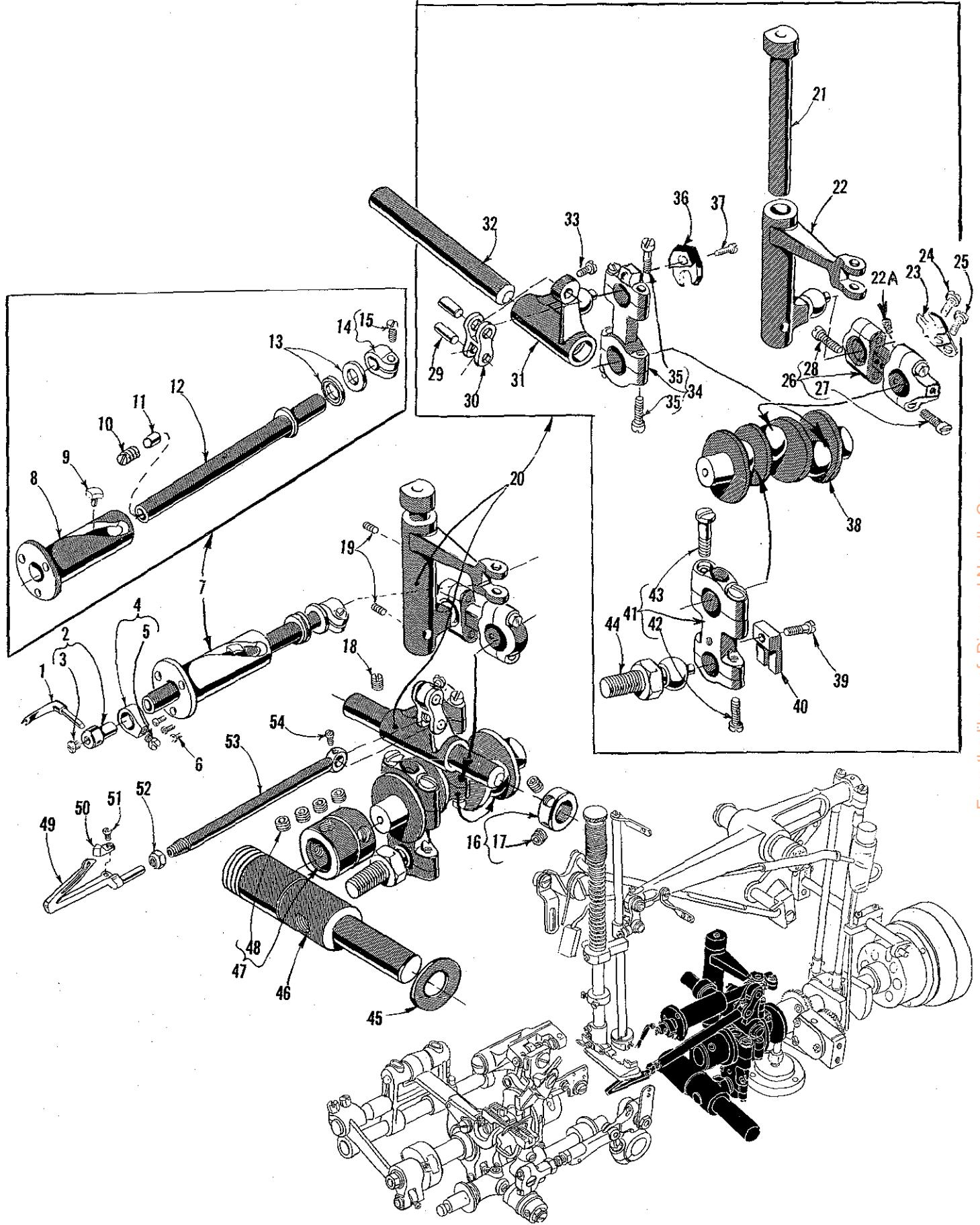
**LOOPER (503) STITCH) AND SPREADER DRIVE MECHANISM**
