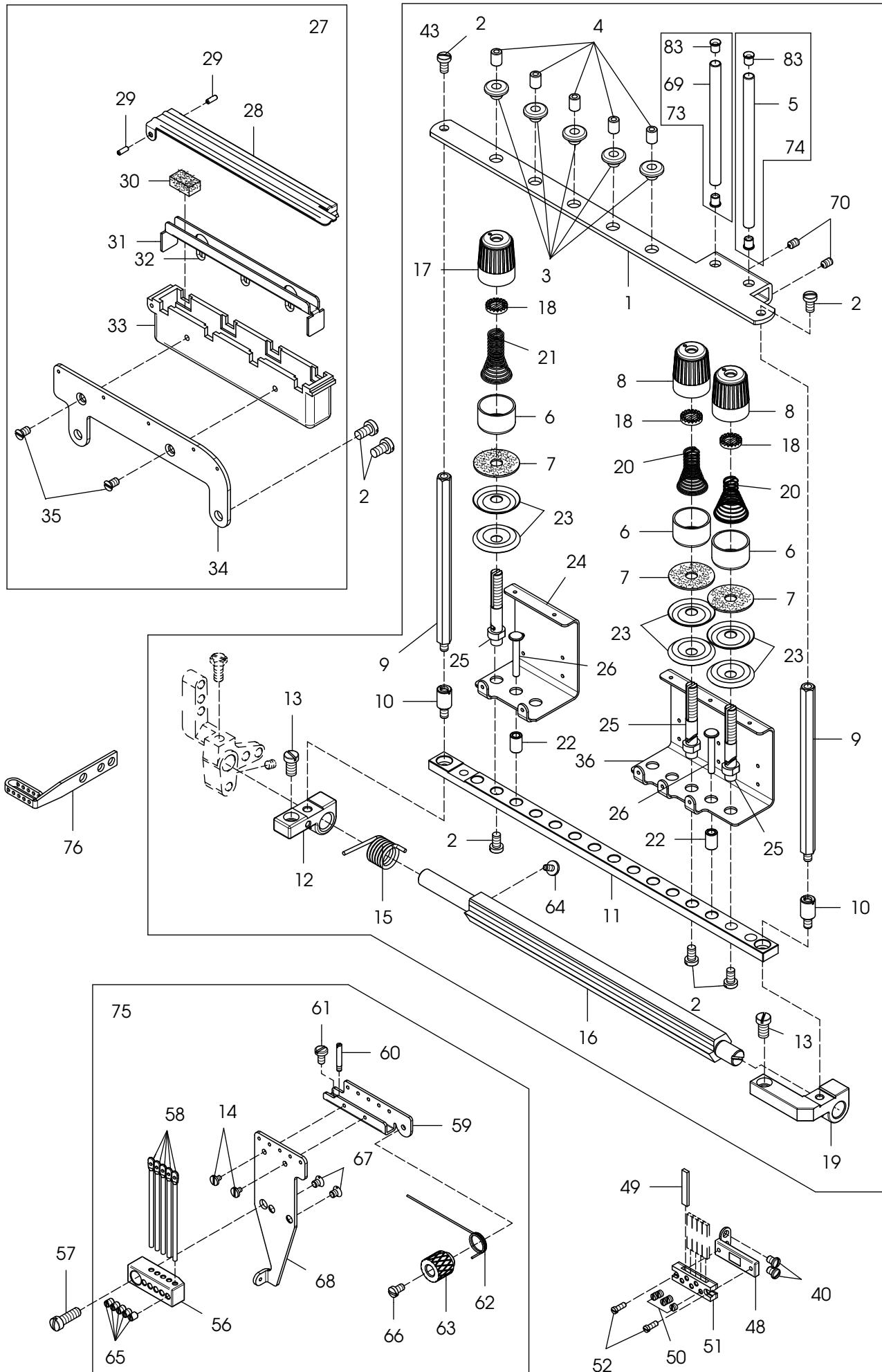
SELECT DEVICE(MISCELLANEOUS THREAD EYELETS-5NEEDLE) 選擇配備(過線機構-五針七線) 33
