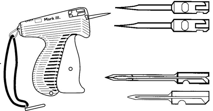
La Pistola SHD de *Trabajo pesado* para agujas largas, con una construcción especialmente robusta y una aguja larga hecha totalmente de acero, para usarse en aplicaciones de sujeción especialmente pesadas, tales como alfombras, cuero o plástico. Las agujas SHD han sido diseñadas para resistir trabajo en materiales pesados, y su construcción de acero ayuda a evitar roturas.
