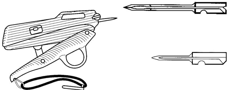
La herramienta **Buttoneer** es útil en muchas aplicaciones de ensamblado: plegado, hilvanado, espaciado, cerrado o unión... toda aplicación que se beneficie de una sujeción rápida, ajustada y económica.
